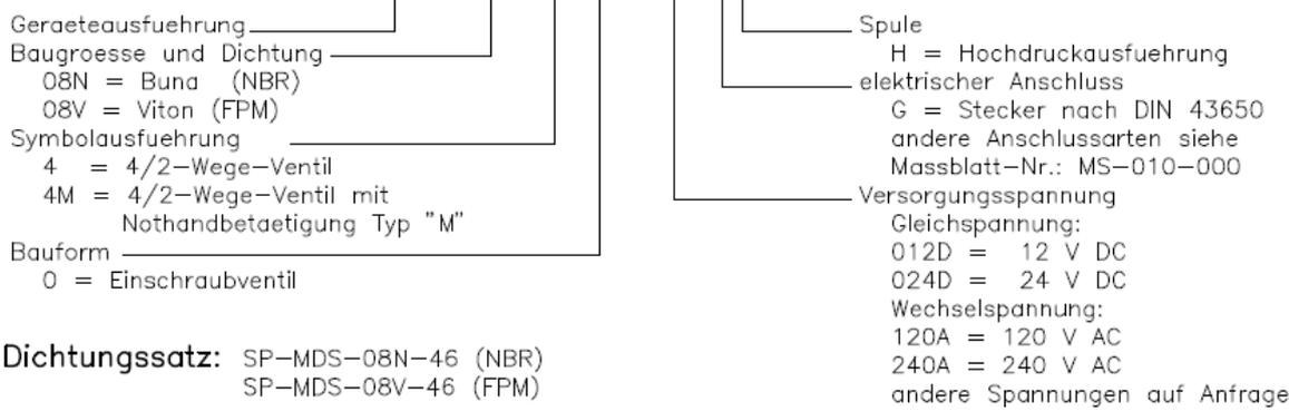
Dichtungssatz: SP-MDS-08N-46 (NBR)
