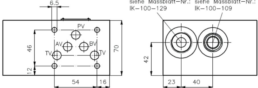
Dichtungstraeger mit einvulkanisiertem O-Ring (Viton FPM) gehoert zum Lieferumfang
